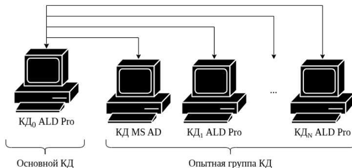
Рис. 1 – Схема подключения КД в стенде, где  $N = 3$ .
